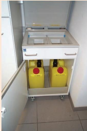
Nachfolgegeneration: Die erste Inbetriebnahme erfolgte 2009 und 2010. Im Jahre 2013 mussten notfallmässig sämtliche Auffangkanister ausgetauscht werden infolge Materialermüdung (plötzliche Rissbildung).
