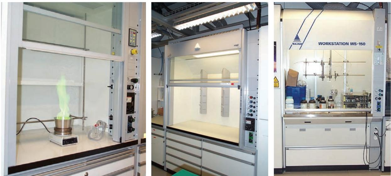
Abb. links: Standard-Laborabzug der 1. Generation; Mitte: Standard-Laborabzug der 2. Generation; Rechts: Skan Workstations
